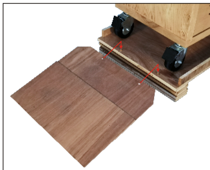
步驟2. 木斜板上有2孔洞對準木棧板側邊開口處的圓樺位置放入
